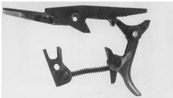
Сборка деталей спускового механизма автомата Константинова
