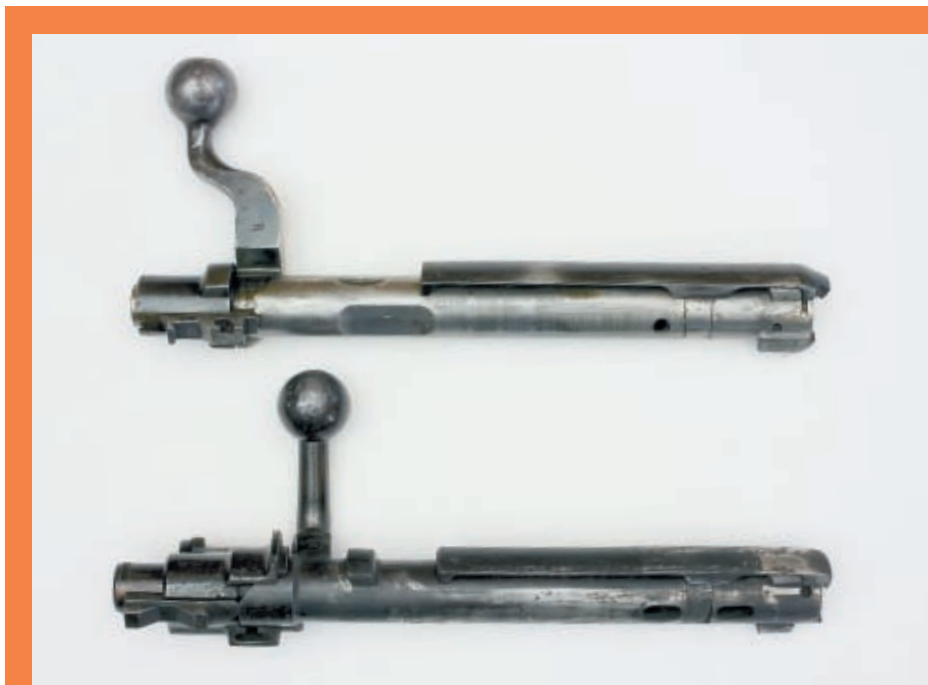
Затвор «Росс-Энфилда» (вверху) практически полностью копирует затвор Маузера. Визуально его легко отличить по форме рукоятки
