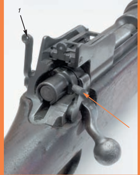
Дополнительный боковой диоптрический прицел, состоящий из подвижной мушки и стойки с диоптром (1), насечённый на дистанцию от 1600 до 2800 ярдов (1560–2550 метров). Предохранитель включен (указан стрелкой)
