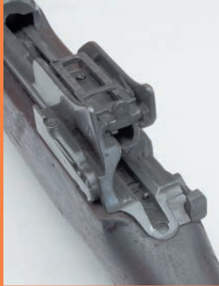
Рамочный прицел установлен для стрельбы на дистанцию прямого выстрела, затвор отделён
