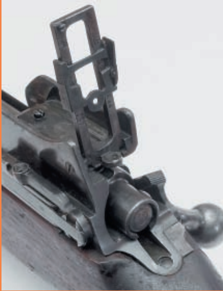
Рамочный прицел с диоптром в боевом положении
