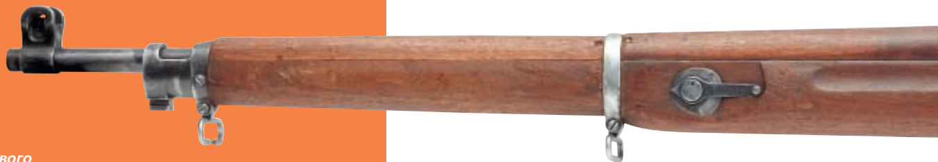
Мушка бокового диоптрического прицела располагается с левой стороны ложи винтовки
