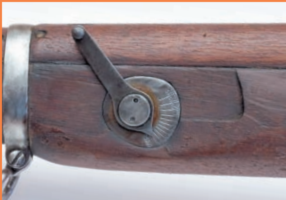
Мушка бокового диоптрического прицела располагается с левой стороны ложи винтовки
