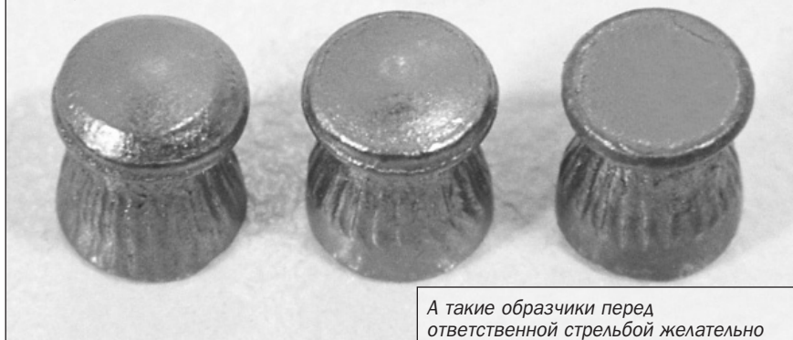
Пули ДЦ не отличаются стабильностью формы – обратите внимание на различную форму головной части
