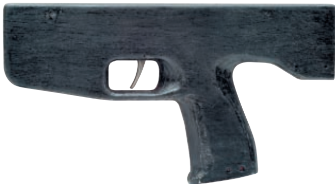
Радикально новая система позволила достичь темпа свыше 3000 выстр./мин. Корпус практически пустой и может быть занят магазином. К сожалению, обычная пружина не успевает подавать шарики с такой скоростью
