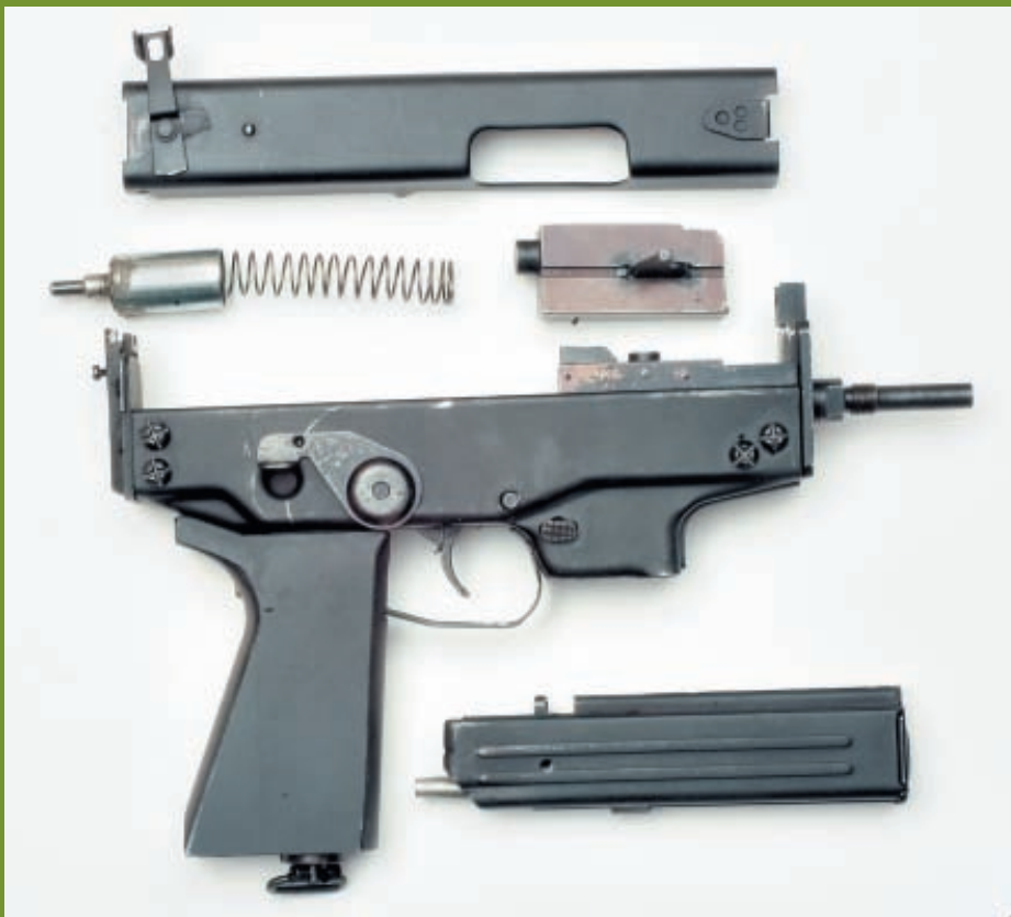
Неполная разборка пневматического газобаллонного пистолета-пулемёта Ti-REX
