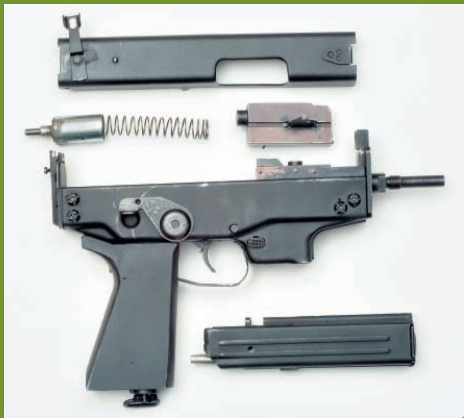
Неполная разборка пневматического газобаллонного пистолета-пулемёта Ti-REX
