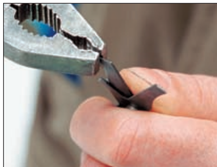
Подгибая зуб толкателя магазина, будьте осторожны, не переусердствуйте
