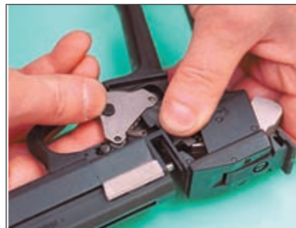
Установка спускового механизма на место
