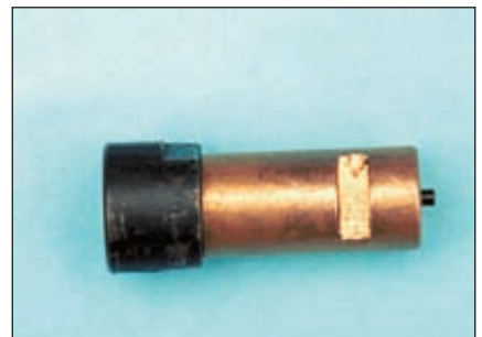
В случае застывания клапанного устройства в корпусе, удалять напльвы необходимо с этой стороны
