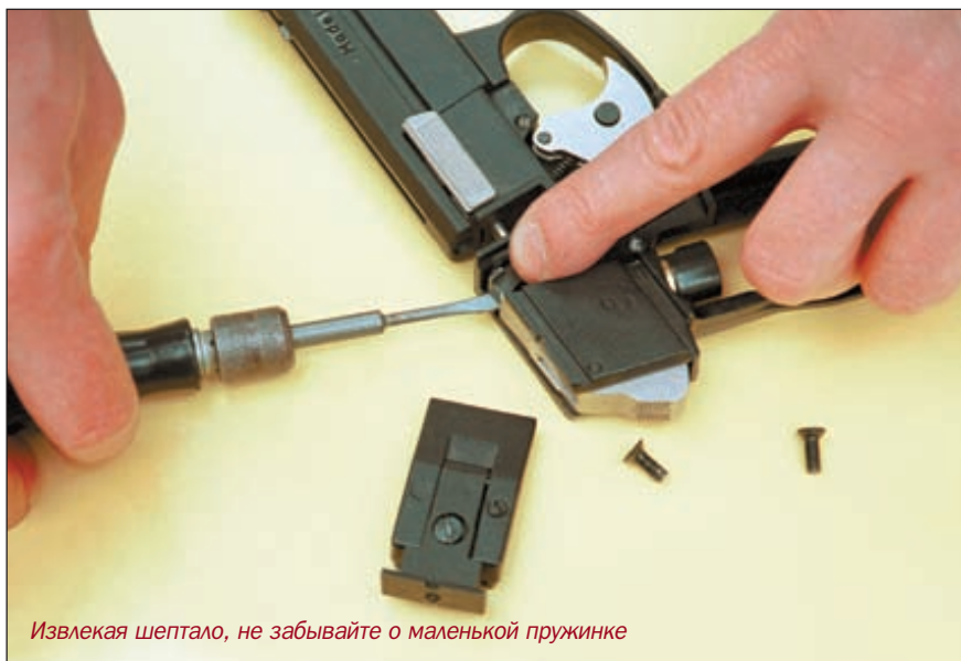
Снимая спусковой механизм, не забывайте о мелких деталях
