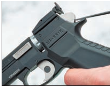
Перед удалением баллончика обязательно стравите газ при помощи шомпола или отвёртки
