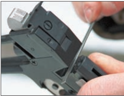
Эту стенку корпуса необходимо подтачивать при тугом ходе магазина
