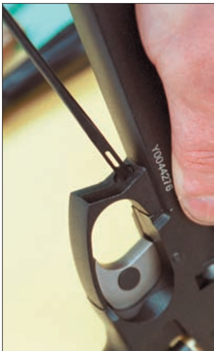
При откручивании винта кожуха ствола кожух необходимо держать прижатым к корпусу пистолета
