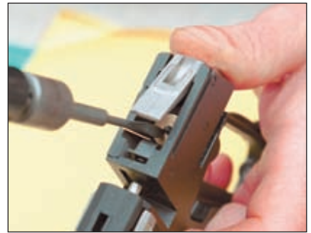
Если клапанное устройство застряло в корпусе, необходимо снять прицельную колодку и выбить устройство сверху
