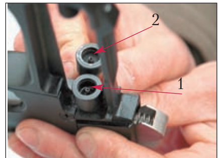
В клапанном устройстве 1 видна неправильная заточка иглы. В номере 2 игла заточена правильно, удалено большое уплотнительное кольцо и установлена самодельная нижняя прокладка
