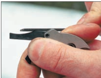
Скругление боковой грани толкателя курка
