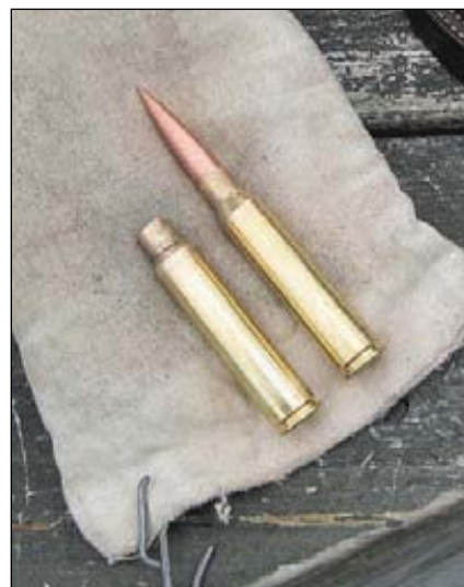
Справа .408 Cheytac, слева «отформованная» в патроннике Шихейна гильза BAS
