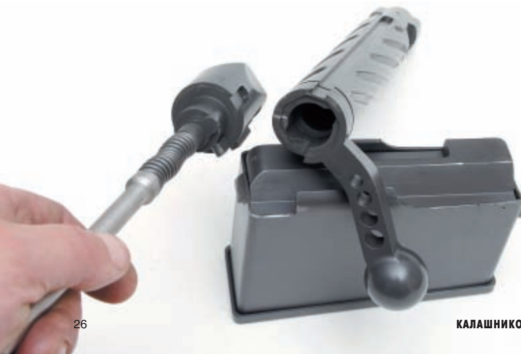
Для облегчения затвор SR-20 имеет отверстия в рукоятке и глубокие винтовые долы на стебле, которые также служат для сбора пыли с целью исключения затирания при повороте затвора. Интересно, что при демонстрационной стрельбе из новой винтовки ударник «прожил» всего 5 выстрелов
