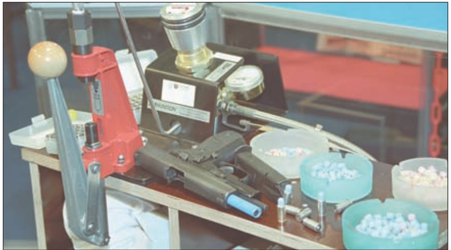
Специальная оснастка для снаряжения компрессионных патронов пластиковой пулей или маркером, которые, при использовании сменного ствола, можно применять для тренировочных стрельб из большинства современных пистолетов
