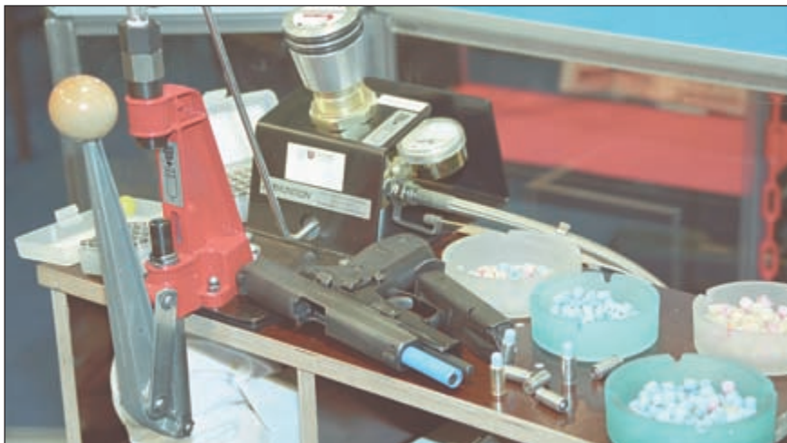
Специальная оснастка для снаряжения компрессионных патронов пластиковой пулей или маркером, которые, при использовании сменного ствола, можно применять для тренировочных стрельб из большинства современных пистолетов
