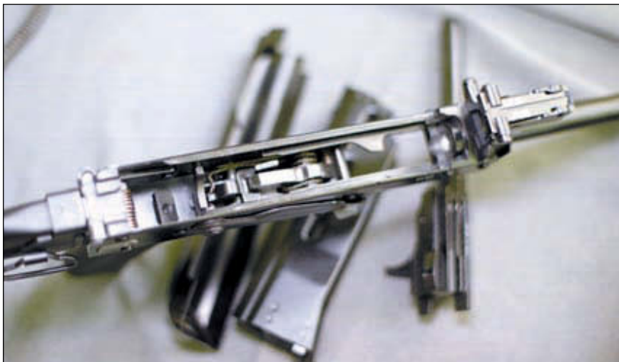
Ударно-спусковой механизм пистолета-пулемёта «Бизон», курок взведён. УСМ «Бизона» позволяет вести огонь одиночными выстрелами и очередями.
