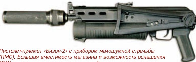
Пистолет-пулемёт «Бизон-2» со шнековым магазином, выполненным из термопластичного стеклонаполненного полиамида.
