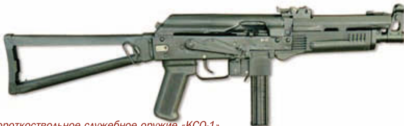
Короткоствольное служебное оружие «КСО-1». Образец разработан на базе пистолета-пулемёта «Бизон». Используемый патрон 9x17К. Вместимость магазина 10 патронов, УСМ допускает ведение огня только одиночными выстрелами.
